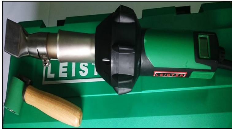
Figure 14. Matériel de soudure de la géomembrane.
